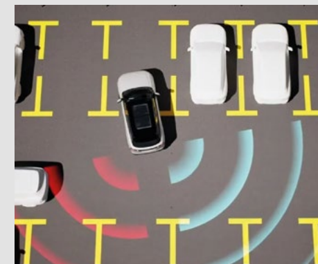
System ostrzegania przed kolizją podczas cofania (RCW)
