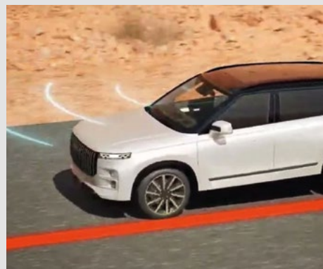
System zapobiegający niekontrolowanej zmianie pasa ruchu (LDP)
